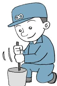
低減材投入後、30秒間よく攪拌してください。攪拌後3分ほどで流し込みが可能な状態となります。(外気温による作業時間の調整は必要ありません。)
