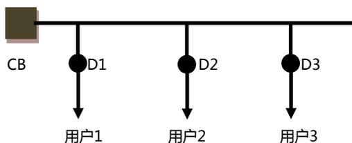
正常时，变电站断路器及各分界开关D1、D2、D3均处于合闸状态
