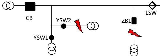
CB：带时限保护（限时速断，过流，零序）和二次重合闸功能的馈线出线断路器
