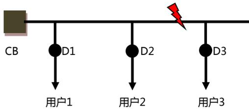
假设分界开关D3的电源侧发生单相接地，由于故障点在D3电源侧（界外），D3不动作，D1和D2同样判断故障在界外而不动作。由变电站处理故障。
