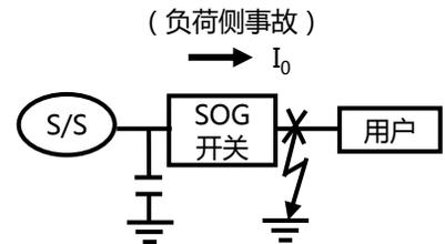
2. 而当开关负荷侧的电缆线较长，有较大的对地电容的时候，如果在开关的电源侧发生接地事故，也会产生较大故障电流。单凭电流无判据会造成开关误动作。
