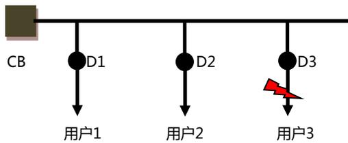
假设分界开关D3的负荷侧发生单相接地，经过对零序电压信号和零序电流信号的检测，判断出D3负荷侧M1发生接地故障，并且在故障持续一定时间后，判断为永久单相接地故障，负荷开关自动分闸，将事故区域隔离。
