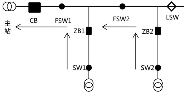
CB：带时限保护（限时速断，过流，零序）和二次重合闸功能的馈线出线断路器
