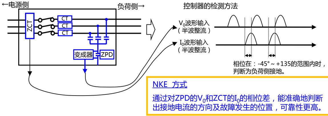
◆高精度性：高性能零序传感器（ZCT）检测微电流
