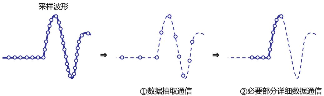
考虑保养方便性·构造成本等各因素,尽可能简化现场装置处理演算功能。以上的通信是采用后台软件对于必要的演算数据提出上传请求,现场装置应答的方式。
