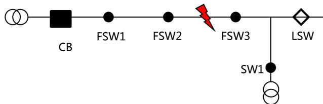
CB：带时限保护（限时速断，过流，零序）和二次重合闸功能的馈线出线断路器
