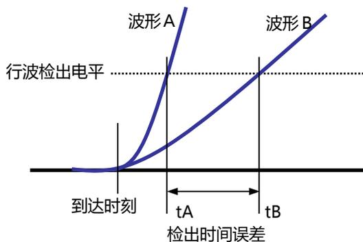
采用分离计算技术，对固有杂波和故障行波分别演算。此方法与单纯的微分演算相比，固定杂波频率成份对故障波计算的影响非常小。
